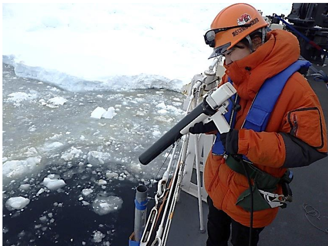
トッテン氷河沖にて船上からXCTDセンサーを投下した
